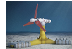
国内初の500kW規模潮流発電機(海底設置型)
