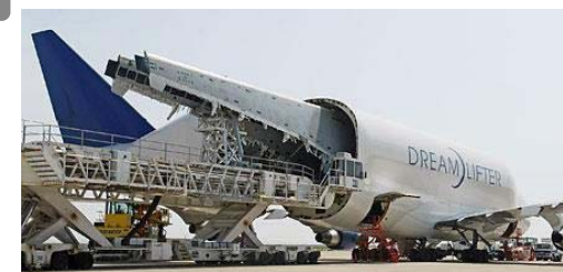
ボーイング787部品の専用輸送機(ボーイング747「ドリームリフター」)への積み込み
