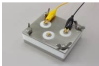
試験用マグネシウム蓄電池セル
