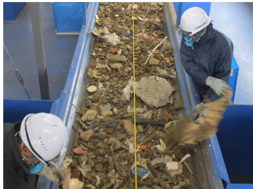
中間処理施設での処理状況(手選別処理)
