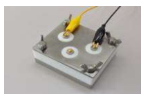
試験用マグネシウム蓄電池セル
